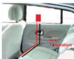
Kablerne trækkes så transponderen nemt kan tilsluttes strøm.
